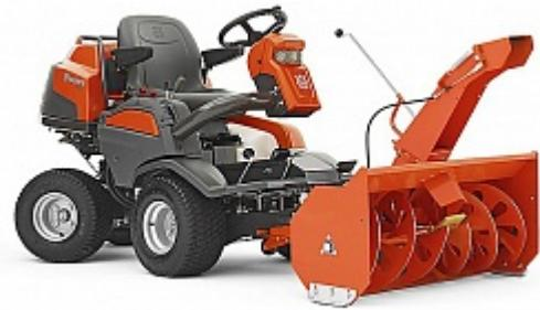
В зависимости от вида требуемых работ по расчистке снега, на трактор можно установить снегоотвал шириной 120 см, роторный снегоотбрасыватель шириной 100 см, или щетку шириной 120 см.
