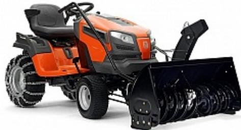
В зависимости от вида требуемых работ по расчистке снега, на трактор можно установить снегоотвал шириной 122 см, роторный снегоотбрасыватель шириной 107 см, или щетку шириной 100 см.
